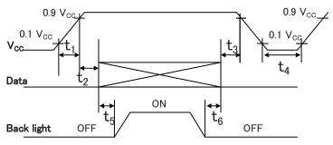
$$\begin{array}{ccccc} 20 \text{us} & < & t_1 & \leqq & 10 \text{ms} \\ 0 \text{s} & < & t_2 & \leqq & 20 \text{ms} \\ 0 \text{s} & < & t_3 & \leqq & 1 \text{s} \\ & 1 \text{s} & \leqq & t_4 \\ 300 \text{ms} & \leqq & t_5 \\ 300 \text{ms} & \leqq & t_6 \end{array}$$
