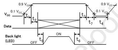
$20 \, \mu \, \text{s} < \qquad t_1 \qquad \leqq \quad 10 \, \text{ms}$   $0 \qquad < \qquad t_2 \qquad \leqq \quad 500 \, \text{ms}$   $0 \qquad < \qquad t_3 \qquad \leqq \quad 1 \, \text{s}$   $1 \, \text{s} \qquad \leqq \qquad t_4$   $300 \, \text{ms} \leq \qquad t_5$   $200 \, \text{ms} \leq \qquad t_6$   $t_7 \qquad \leqq \quad 100 \, \text{ms}$
