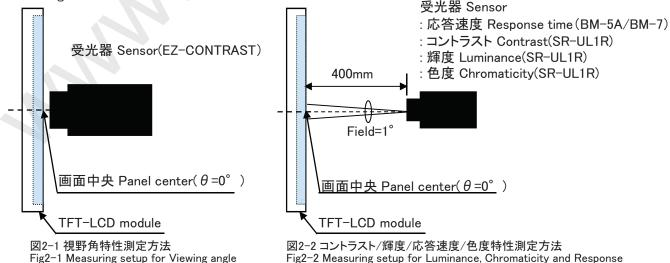
図2 光学的特性測定方法
