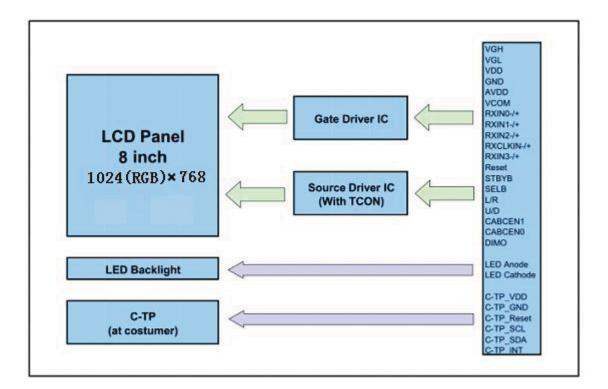
LCD module diagram
